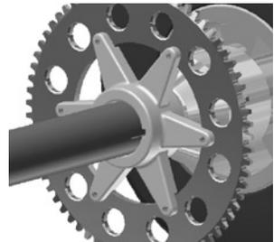
Depois de ter realizado estes passos, a flange extrudida adapta-se a um comprimento definido pela localização do furo de montagem do carreto.
